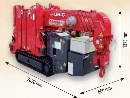
DER UNIC URW-295 ist der erste Minikran in Europa, der schmal genug ist, um durch einen Standardtürrahmen zu fahren, aber eine Tragkraft von fast 3 Tonnen aufweist.
